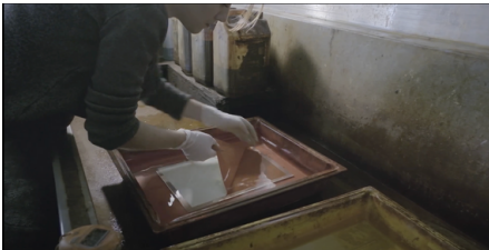
opération chimique pour graver la plaque
